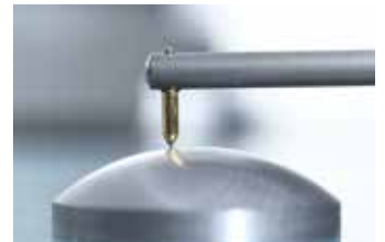
Die Entstehung eines Diamanten. Oben: Mit einem Laser werden präzise alle Unebenheiten an der Oberfläche entfernt. So wird sichergestellt, dass die Geometrie aller Kalotten exakt gleich ist. Rechts: Fertige Diamantkalotten, auf deren Oberfläche zum Schutz bereits eine Platinschicht aufgebracht wurde.
