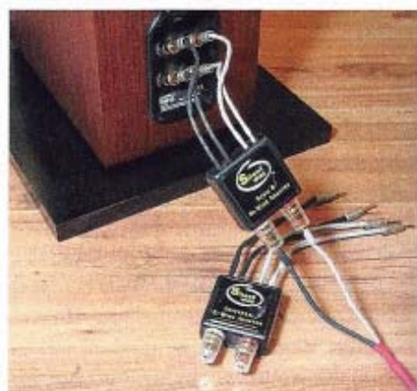
Bi-Wiring-Adapter ersetzen einfache Blechbrücken. Hier zwei verschiedene von Silent Wire
